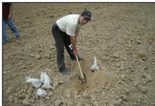
Figura 3. Extracción de muestreo de suelos.
