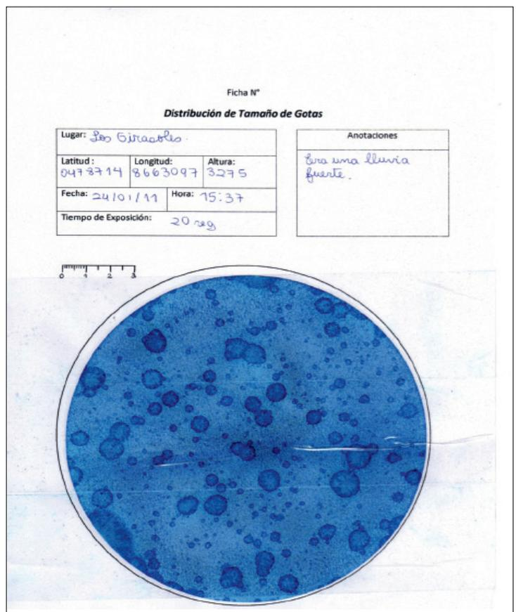
Figura 3.44 Una muestra de la técnica de papel de filtro, un papel de filtro circular teñido con azul de metileno y expuesto a las gotas de lluvia, las manchas oscuras se relacionan con el tamaño de las gotas antes de impactar el papel.
