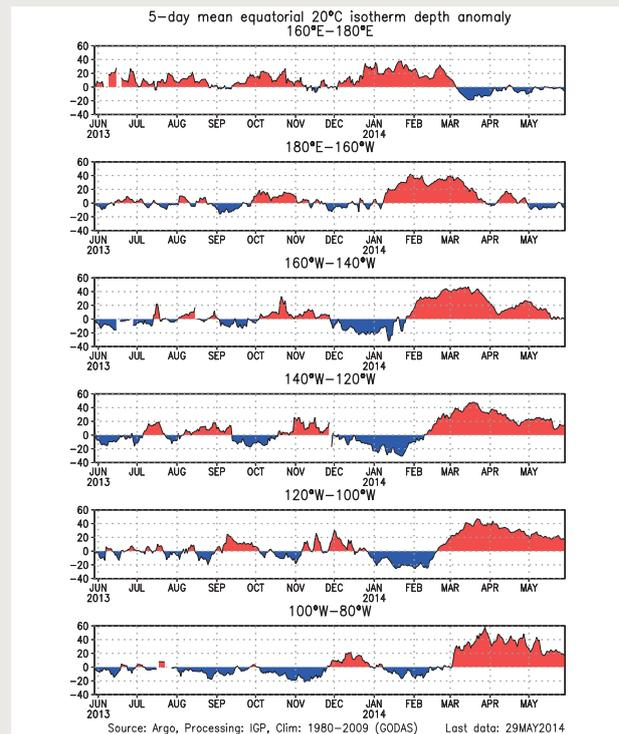
Figura 3. Series de tiempo de la anomalía de la profundidad (m) de la termoclina ecuatorial ( $2^{\circ}\text{S}-2^{\circ}\text{N}$ ) promediada sobre seis sectores del Pacífico ecuatorial de 20 grados de longitud y con una media móvil de cinco días. La serie superior (inferior) pertenece al extremo oeste (este).
